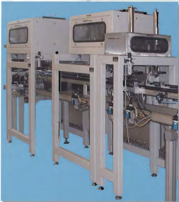
安全气囊混合点燃装置的填充设备 AEW 811KL - 814KL Dual 重力填充工艺 VDE 0166E1(IP65-T4/T5)
