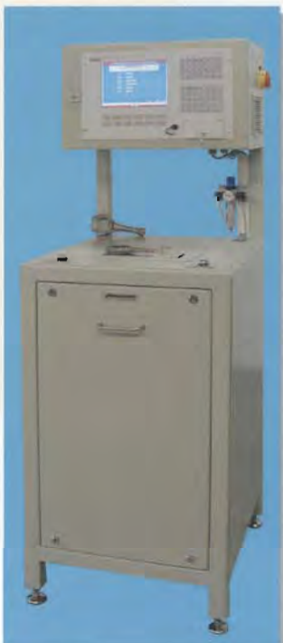
连杆监控称量设备 AEW 601-01 用于检查大小孔的 手检设备 400-1200克 偏差: +/-300毫克
