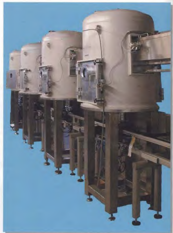
带有安全罩的安全气囊点燃装置填充设备
